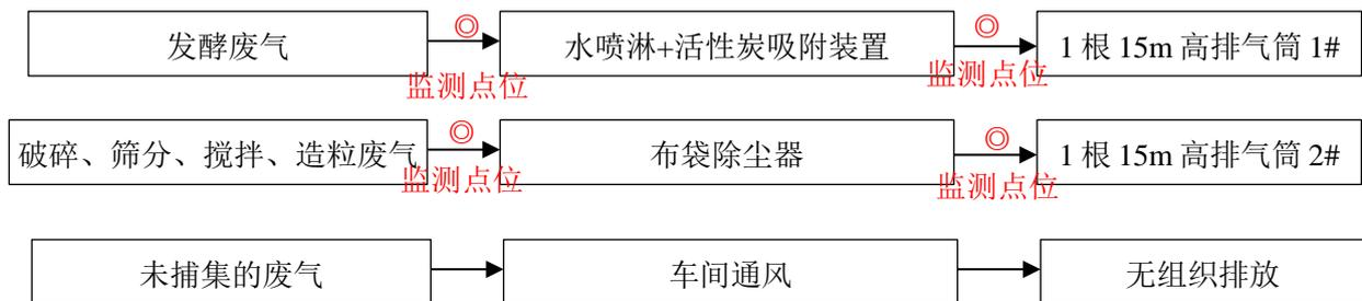
图 3-1 废气处理工艺流程图及监测点位图
