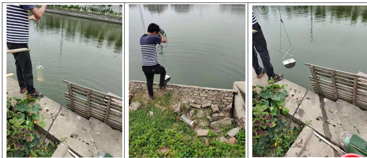
图 5.5 地表水和底泥现场采样照片
