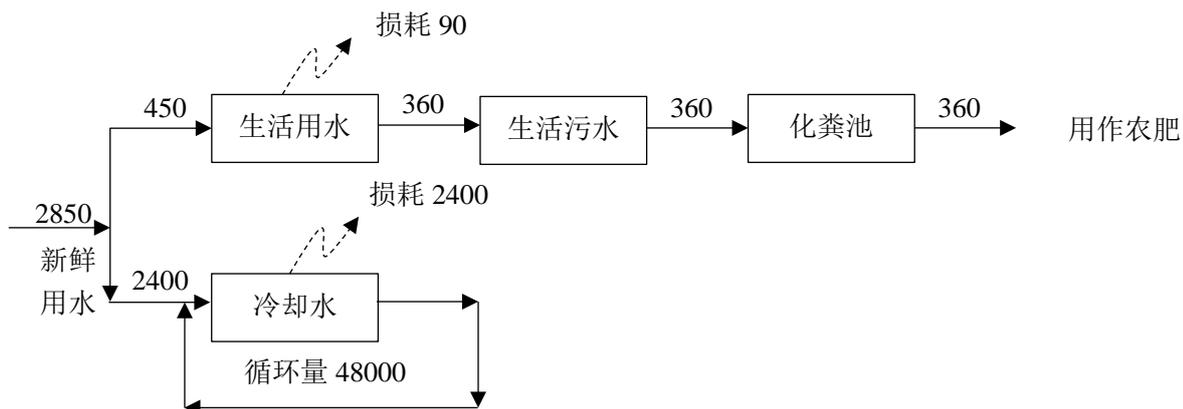
图 2-1 项目建成后水平衡图 (t/a)
