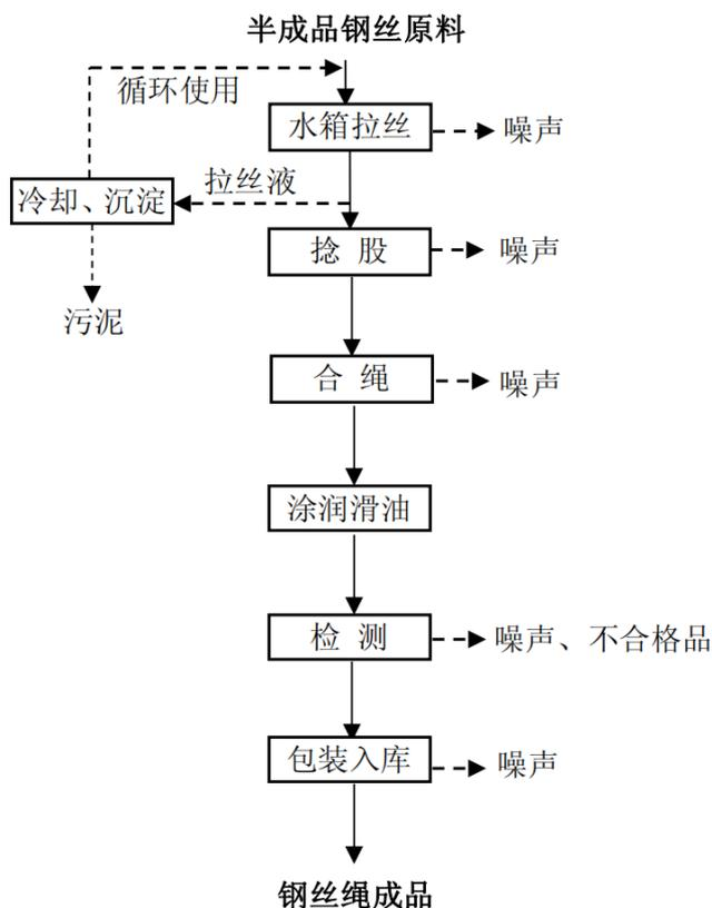
图 2-2 钢丝绳生产工艺流程及产污环节图
